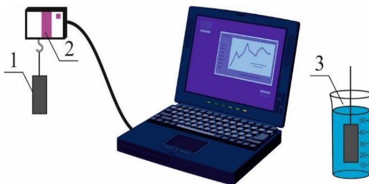
Рис. 3. Схема установки: 1 – исследуемое тело, 2 – датчик усилия, 3 – емкость с водой
