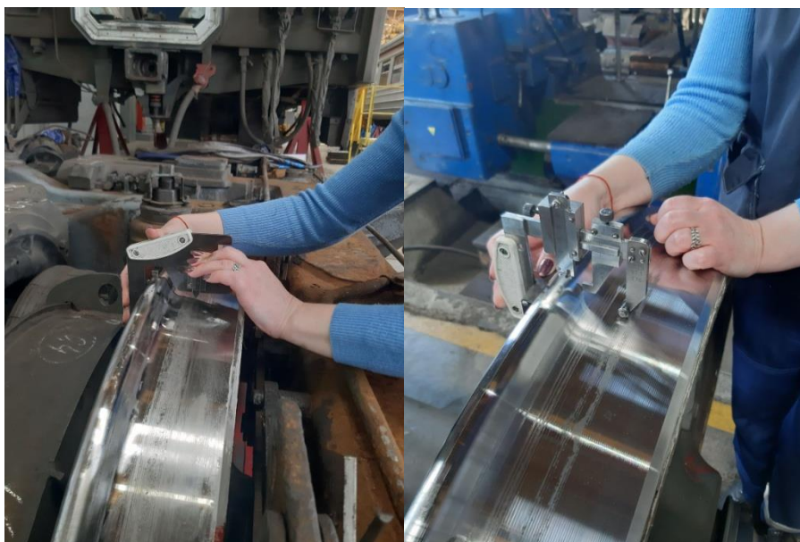
Рис. 2. Фрагмент видеосвязи с преподавателем, на котором согласовывается методика измерения геометрических параметров колес
