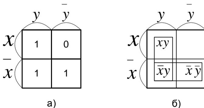
Пара единиц во второй строке таблицы 8а соответствует переменной  $\bar{x}$ , а пара единиц в первой колонке – переменной  $y$ . Поэтому данная функция может быть записана в виде  $f_{13}(x, y) = \bar{x} \vee y$ . Это выражение, являющееся минимальной формой функции  $f_{13}(x, y)$ , получено по существу путем склеивания конститuent единиц, обведенных овалами в таблице 8б.
