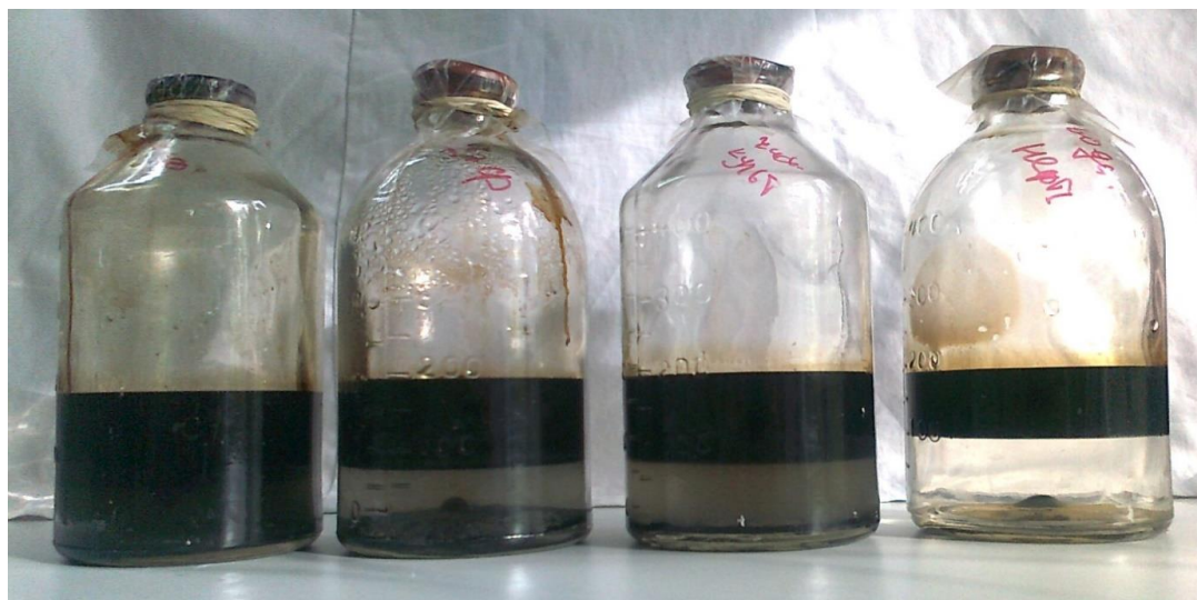
Рис. 2. Имитация нефтяного разлива с добавлением нефтедеструкторов: (слева направо) 1 – контроль, 2, 3 – с добавлением ассоциации бактерий, 4 – после биодеструкции ассоциацией штаммов бактерий в течение 3 суток инкубирования при температуре 12°C и pH 7,0
