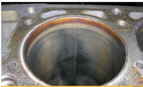
Рис. 2. Абразивное изнашивание цилиндров
