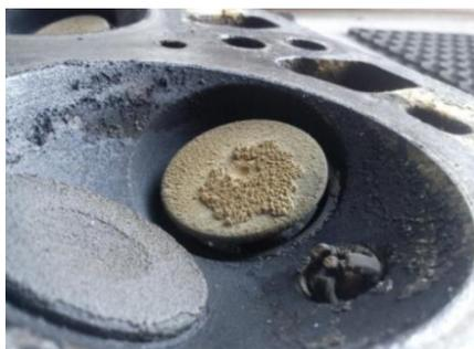
Рис. 3. Отложения на впускном клапане
