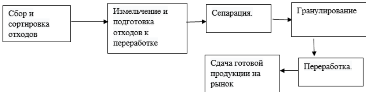
Рис. 1. Технологическая схема по переработке строительных отходов
