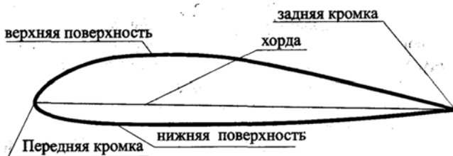
Рис. 2 Схема крыла для БПЛА
