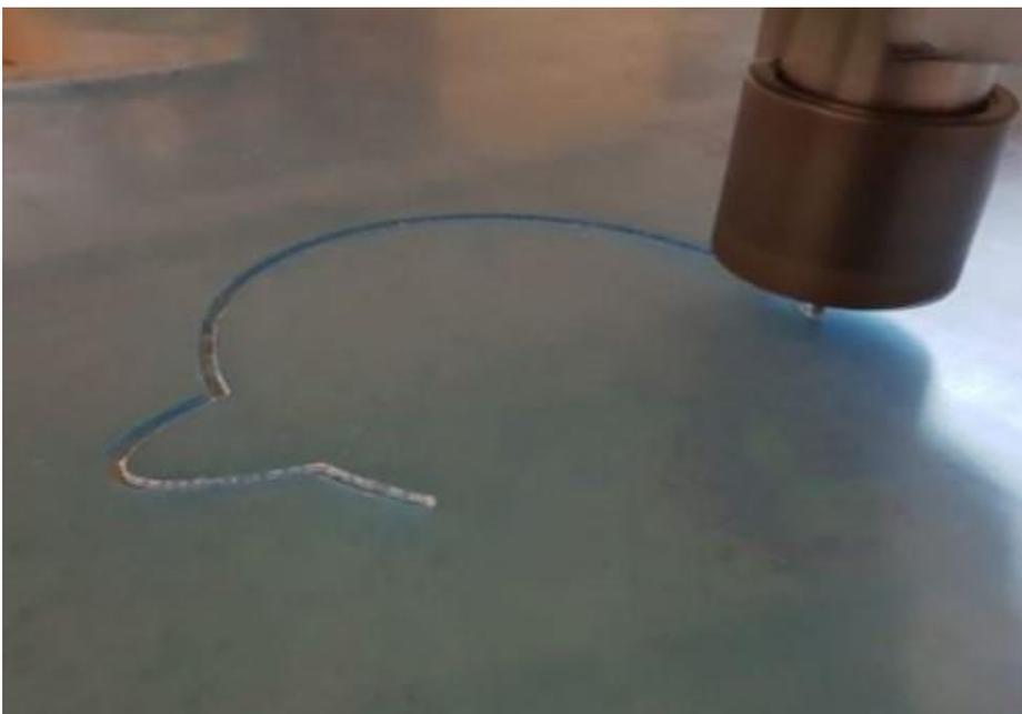
Рис. 2. Процесс фрезерной резки обложки буклета
