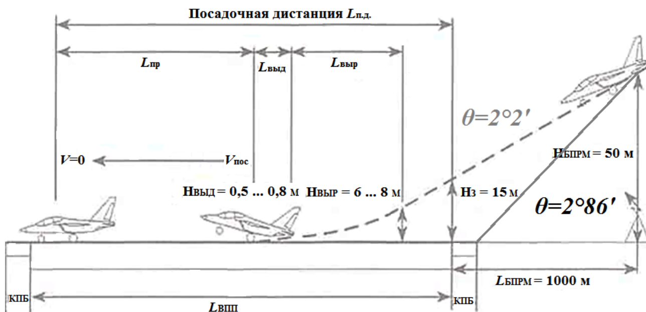
Рис. 1. Схема захода на посадку
