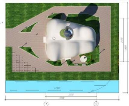
Покрытие здания запроектировано из полимерторкретжелезобетона, армированного сетками.
