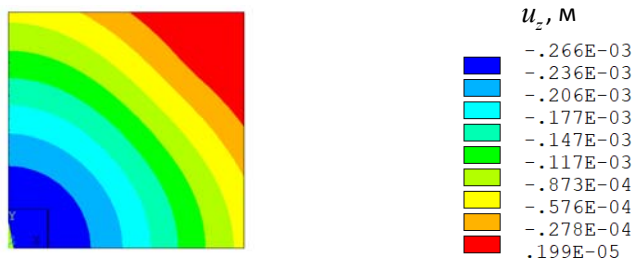
Рис. 4. Визуализация распределения поля u_z (ANSYS)
