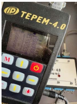
Рис. 7. Процесс измерения прибором Терем 4.0
