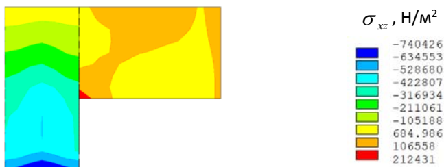
Рис. 15. Распределение напряжений \sigma_{xz} в узле (ANSYS)
