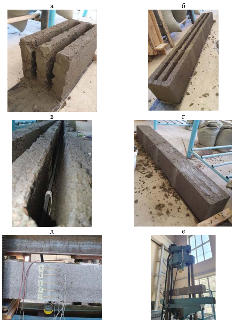
Рис. 4. Экспериментальные исследования комплексной перегородки: а-г этапы изготовления образцов, д-размещение тензодатчиков, е-образец, подготовленный к испытаниям на прессе
