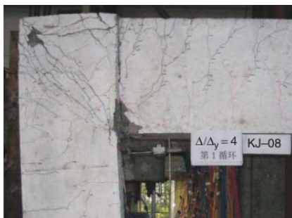
Рис. 17. Фотография разрушения portalного узла (эксперимент [10])
