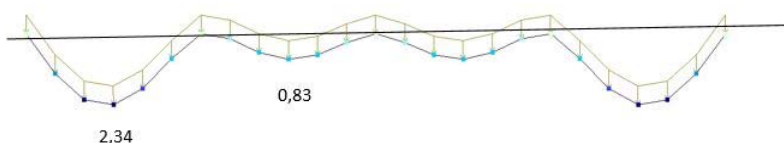
Рис. 5. Прогiby на начальном этапе в упруго-пластической задаче
