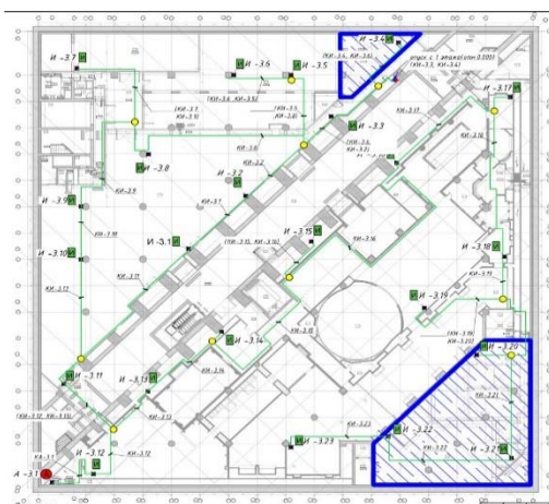
Рис. 4. Расположение инклинометров и акселерометров у фундаментной плиты
