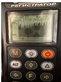
Рис. 2. Построенный график на экране теплографа в результате исследования участка стены
