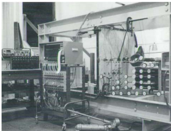
Рис. 1. Стенд для испытания квадратной в плане плиты на продавливание [4]
