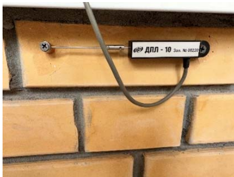
Рис. 6. Датчик Д8 в наружной многослойной стене
