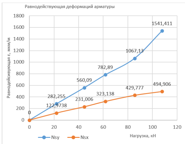
Рис. 10. Рост деформаций арматуры направлений Y и X (просуммировано по двум лучам направления)
