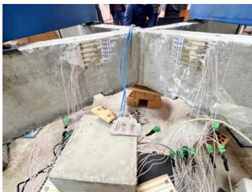
Рис. 5. Фото расположения тензорезисторов
