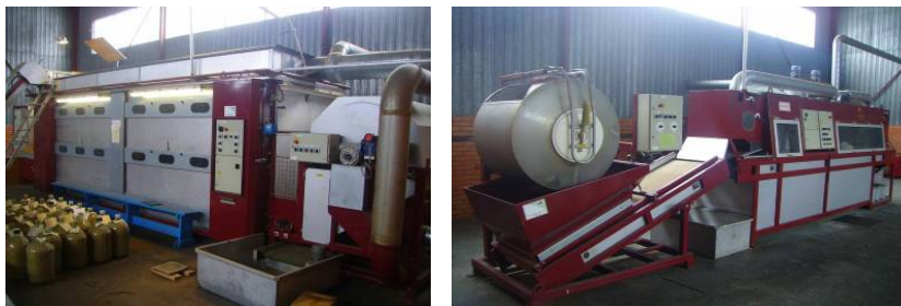
Рис. 4. Шишкосушилка типа SAMPRO (слева), водный обескрыливатель и линия по сортировке и подсушиванию семян (справа)
