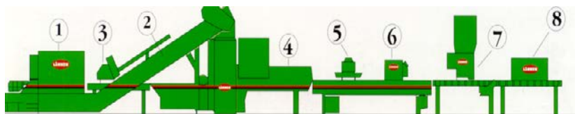
Рис. 7. Линия на набивке кассет торфом, посеву семян и мульчированию фирмы LANNE, Финляндия:
