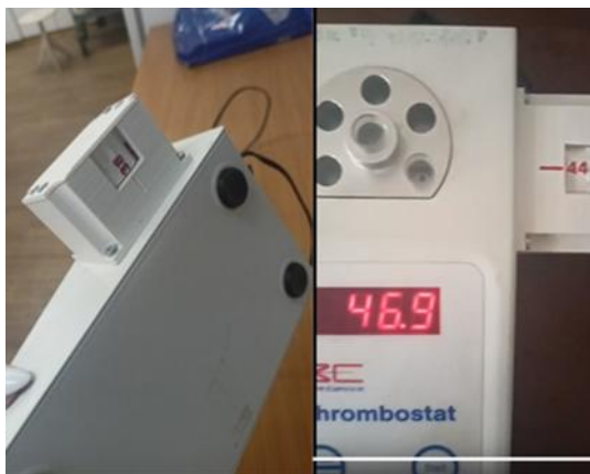
Рис. 1. Модифицированный ветеринарный коагулометр
