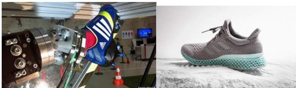
Рис. 3. 3D-печать обувной набивки и подошв
