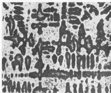
Рис. 5. Микроструктура литой оловянистой бронзы
