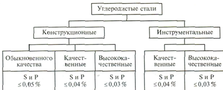
Рис. 31. Классификация углеродистых сталей по назначению и качеству
