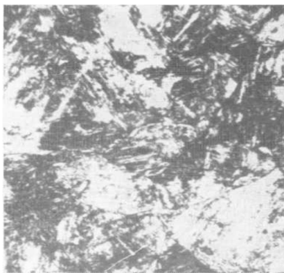
Рис. 8. Структура нержавеющей стали 3X13 в термически обработанном состоянии (мартенсит и карбиды)
