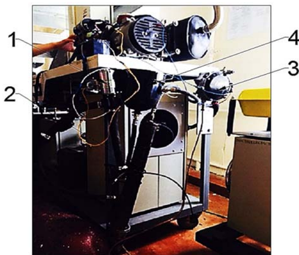
Рис. 3.9. Вид модернизированного стенда с установленным ГБО – 2: 1 – насос, 2 – ТЭН, 3 – редуктор низкого давления, 4 – расширитель
