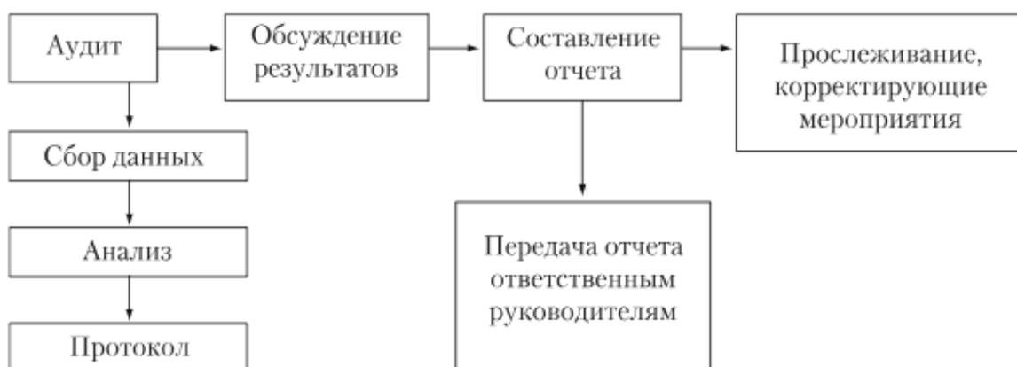
Рис. 3. Процесс проведения аудита качества на предприятиях
