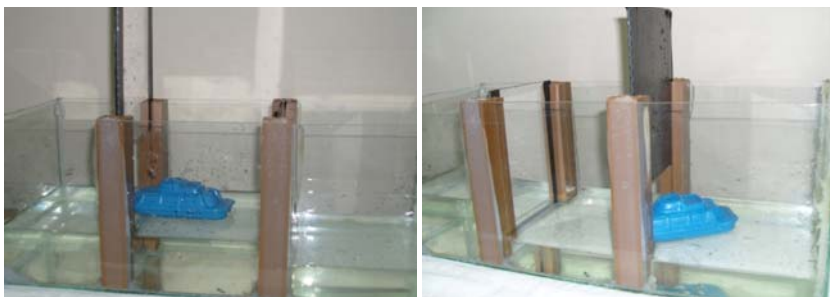
Рис. 1. Модель технического устройства, позволяющего перемещать судно с одного уровня воды на другой
