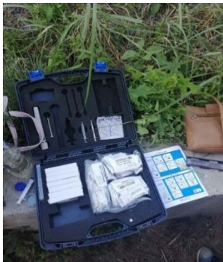
Рис.2. Переносная экспресс мини-лаборатория для определения концентраций загрязняющих веществ
