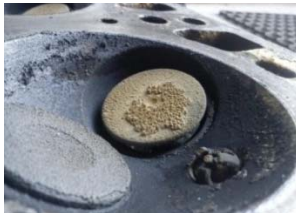
Рис. 3. Отложения на впускном клапане
