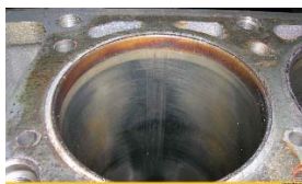
Рис. 2. Абразивное изнашивание цилиндров
