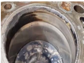
Рис.5. Нагар на гильзе цилиндра вследствие разрыва верхнего компрессионного кольца
