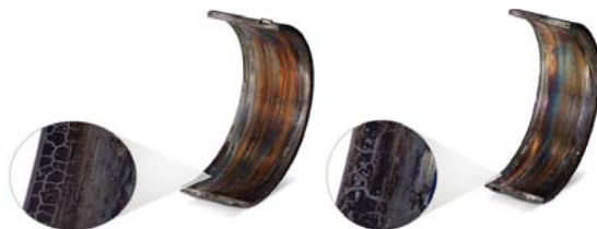
Рис.7. Вкладыши шатунного подшипника со стороны крышки и шатуна, композит сталь-бронза с гальваническим покрытием
