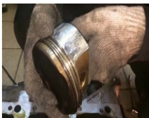
Рис.6. Задиры в зоне юбки поршня
