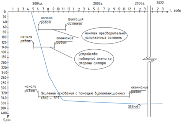
Рис. 2.10. График раскрытия деформационной трещины на уровне карниза стены северного фасада (маяк 1)
