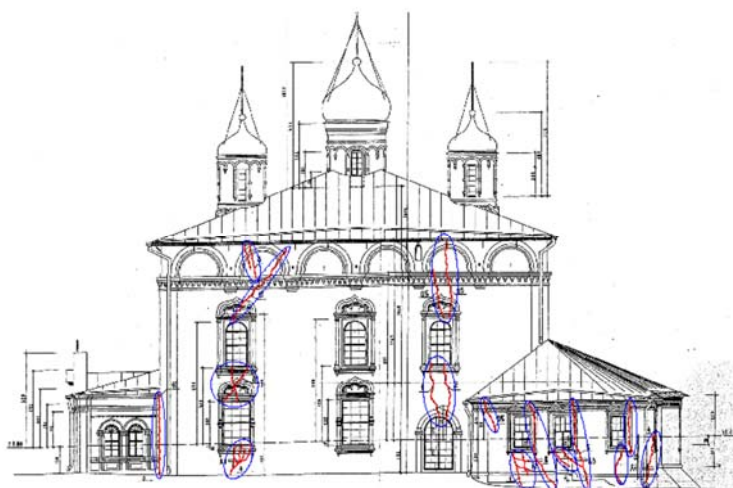
Рис. 2.3. Деформационные трещины на южном фасаде Введенского собора (показаны красным цветом и обведены синими овалами)
