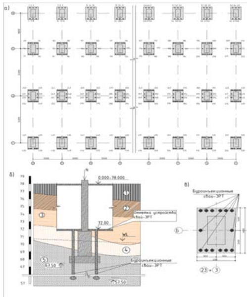
Рис. 2.23: а – план расположения буроинъекционных свай ЭРТ (РИТ, ФОРСТ, ЭРСТ); б – сечение фундамента в осях Д/12 с привязкой в инженерно-геологический разрез; в – план буроинъекционных свай ЭРТ (РИТ, ФОРСТ, ЭРСТ) усиления основания в осях Б/5: 1 – насыпной грунт; 2 – суглинок полутвердый; 3 – супесь; 4 – глина твердая; 5 – пески мелкие водонасыщенные
