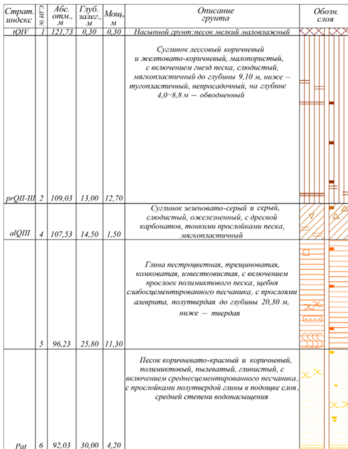
Рис. 2.11. Характерный инженерно-геологический разрез площадки строительства
