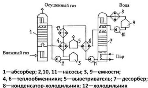
Рис. 2. Аппарат абсорбционного метода осушки газа
