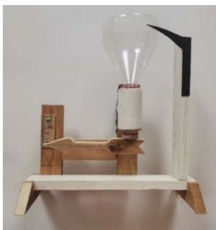
Рис. 7. Прибор для демонстрации гидростатического парадокса.
