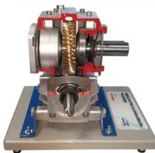
Рис. 2. Модель червячного редуктора на подставке
