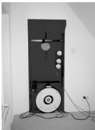
Рис. 2. Испытание на герметичность
