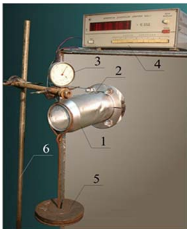
Рис. 1. Испытательный стенд на изгиб
