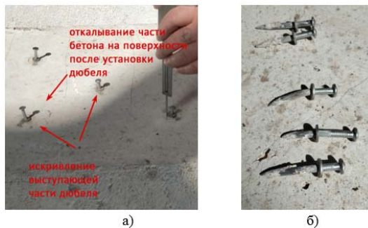
Рис. 3. Искривление выступающей (а) и заглубленной (б) части дюбель-гвоздя
