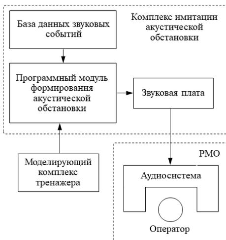
Рис. 2. Структура системы имитации акустических шумов
