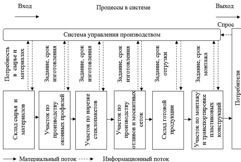
Рис. 1. Система производственной логистики на исследуемом предприятии
