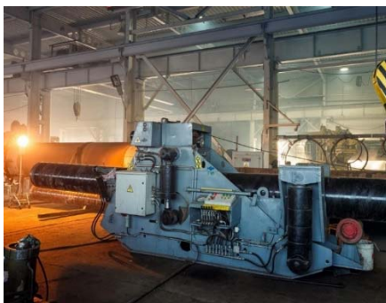
Рис. 4. Процесс холодного гнутья отводов
