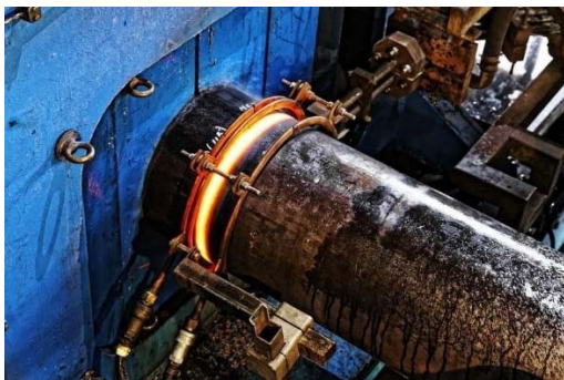
Рис. 2. Процесс горячего гнутья отвода
