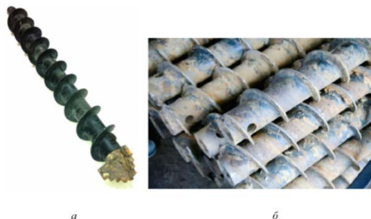
Рис. 1. Шнеки, применяемые при бурении скважин: а – сплошной шнек с трехперьевым долотом, б – полые шнеки.
