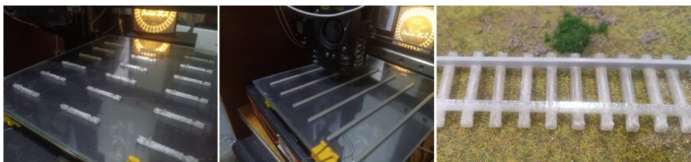
Рис. 4. Составные детали для рельсошпальной решетки
