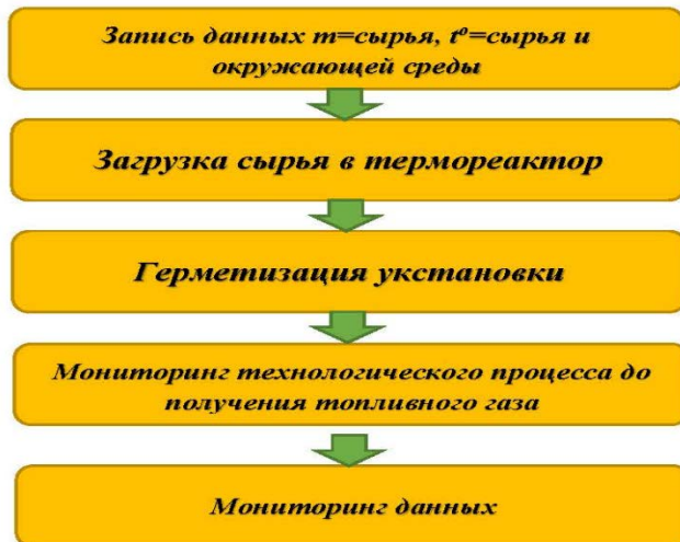
Рис. 3.1. Пошаговая структура методики экспериментальных исследований
