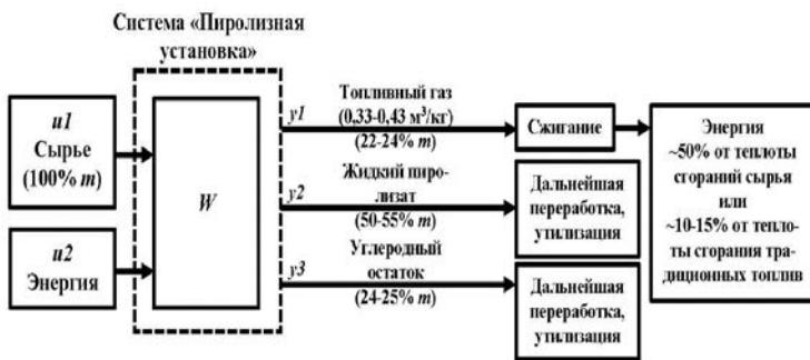
Рис. 2.7. Схема системы «Пиролизная установка» и ее материально-энергетического баланса
