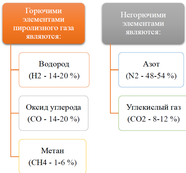
Рис. 2.4. Схема элементов пиролизного газа [6]
