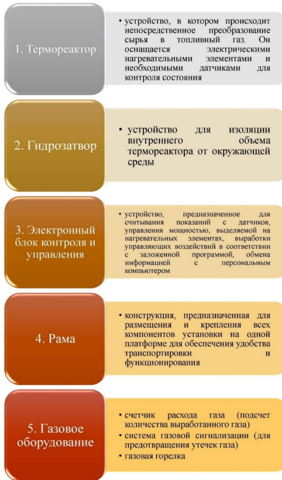
Рис. 3.3. Описание составляющих пиролизной установки ГВА-1
