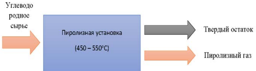
Рис. 2.1. Процесс термического разложения без доступа воздуха
