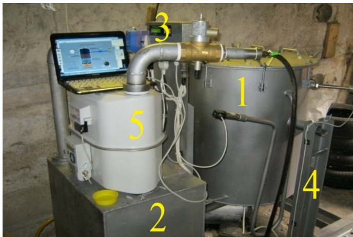
Рис. 3.2. Общий вид пиролизной установки ГВА-1: 1 – термореактор; 2 – гидрозатвор; 3 – электронный блок контроля и управления; 4 – рама; 5 – газовое оборудование
