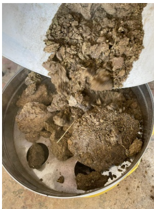
Рис. 3.7. Процесс разделения измельченного навоза на фракции
