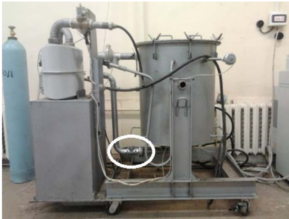
Рис. 4.1. Общий вид установки ГВА-1 с обратным клапаном
