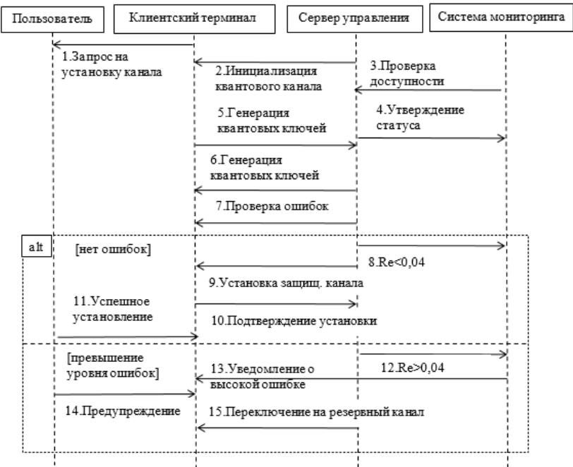
Рис. 3. Диаграмма последовательности «Установка защищенного квантового канала»
