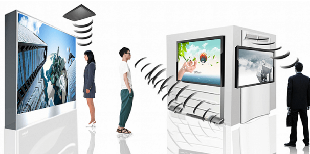
Рис. 2. Система направленного звука для звуковой информационной поддержки. Подходя к стенду, можно услышать информацию про конкретный интересующий вас экспонат
