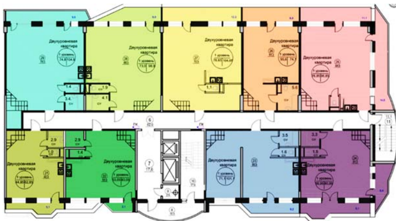
Рис. 2. Планировка этажа двухуровневых квартир существующего здания
