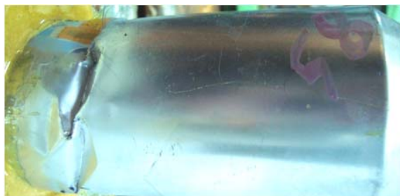
а) остаточная форма образца – вид сбоку
