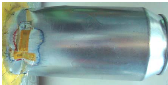
б) остаточная форма образца – вид сверху
