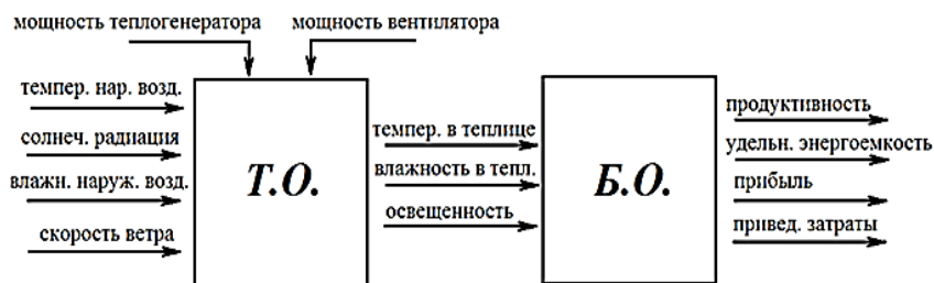
Рис. 1. Теплица как объект управления (биологический и технический) [6]
