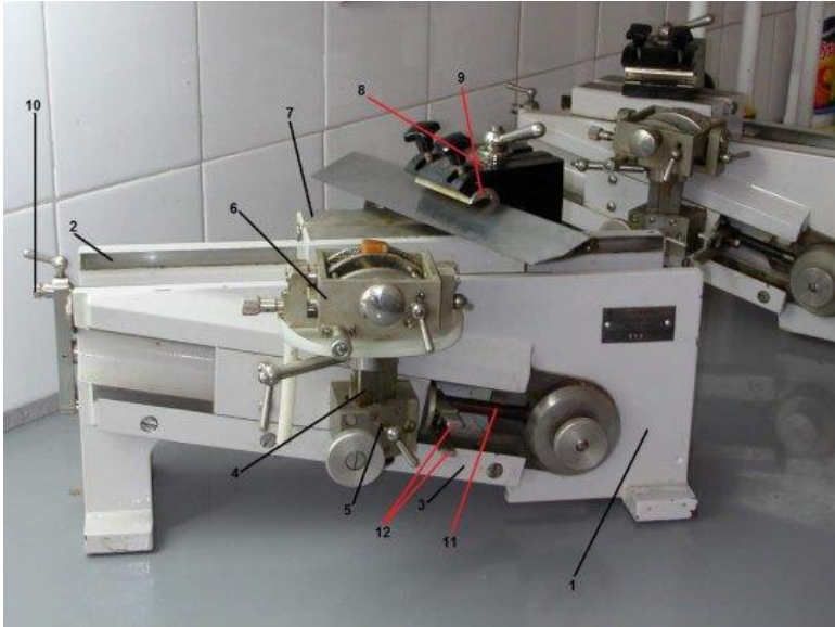
Рис. 2. Устройство салазочного микротомата: 1 – станина, 2 – ножедержатель, 3 – направляющие, 4-5 – механизм подъема, 6 – зажим для блока, 7 – ножевые салазки, 8 – ножедержатель, 9 – втулка, меняющая наклон ножа, 10-12 – механизм микроподачи
